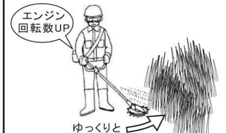
草芝の種類、太さ、密集度合に応じてエンジンの回転数・刃の送り速度を調整してください。草が密集したところではエンジンの回転数を上げ、刃はゆっくり送ってください。
